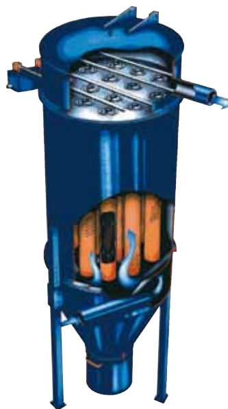
Letkusuodattimen toimintaperiaate, CIRO/L900/9
