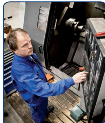
Koneistaja Ilmo Viljamaa työskentelee ATA Gearsilla CNC-sorvilla, johon on liitetty leikkuunestesumujen poistaja Ultra Air.
